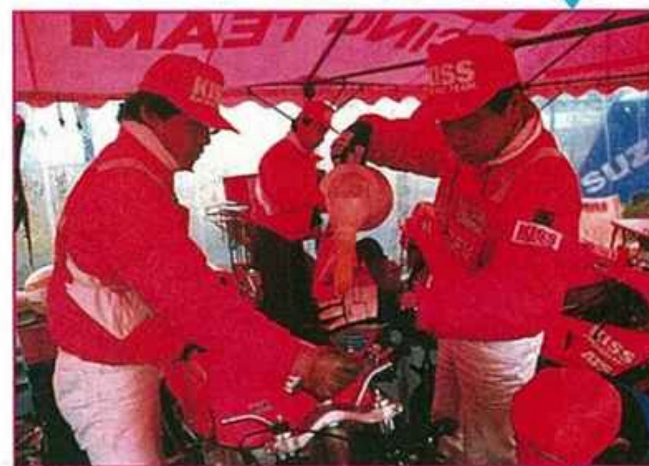
▲オイルを混合したガソリンを入 れる。重量増にならぬよう最低限の量
